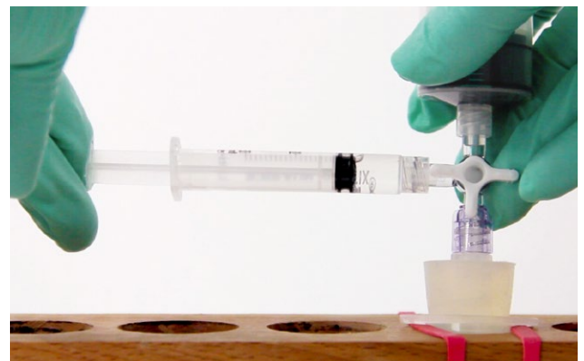
Abb. 2: Das Substrat ( \text{H}_2\text{O}_2 ) wird in die Reaktions-/Enzymspritze eingefüllt.
