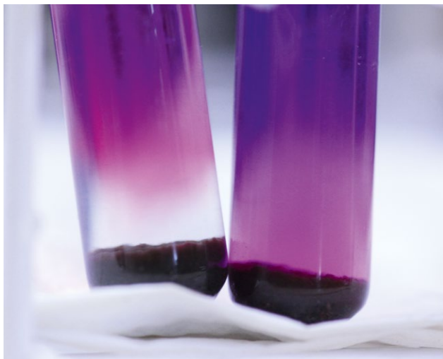
Abb. 2: Vergleich des Sauerstoffverbrauchs in frischen (links) und in abgekochten (rechts) Sedimentproben.
