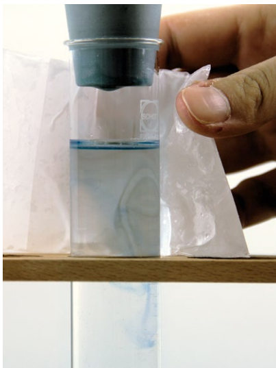
Abb. 2: Das gekühlte Oberflächenwasser sinkt ab.
